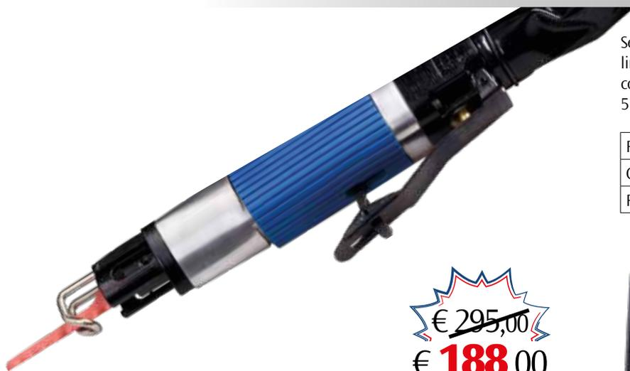
Seghetto pneumatico, utilizzabile anche come limatrice pneumatica. Il kit è fornito in valigetta comprendente 5 lime, 5 lame a 24 denti (24T) e 5 lame a 32 denti (32T).
