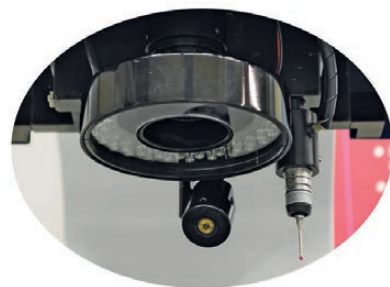
Gruppo ottico con puntatore laser e tastatore
